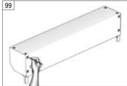
99 Отметьте места для сверления отверстий под заклепки.
