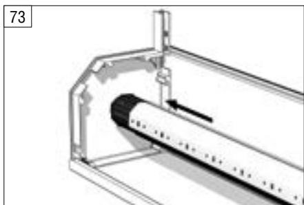
73. Выдвиньте универсальную капсулу из вала, до упора в крышку.
