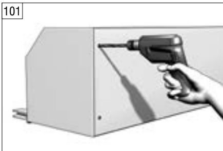
101 Просверлите отверстия в верхней части короба.
