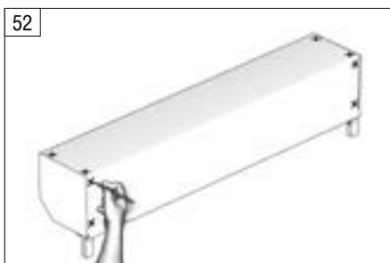
52 Отметьте места для сверления отверстий под заклепки.
