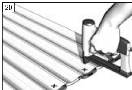
20 Закрепите боковые замки на ламели (для ламелей RH) при помощи скоб. Внимание! Боковые замки устанавливаются через одну ламель.
