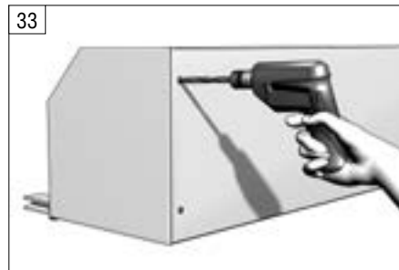
33 Просверлите отверстия в верхней части короба под заклепки Ø4 мм.
