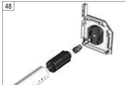
48 Соедините между собой вал, капсулу универсальную, переходник и редуктор предварительно закрепленный на боковой крышке.
