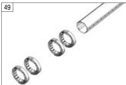
49 В случае комплектации конструкции ригельными кольцами и автоматическими замками (см. стр. 31) наденьте ригельные кольца на октагональный вал.
