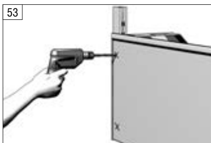
53 Просверлите отверстия в задней части короба под заклепки Ø4 мм.
