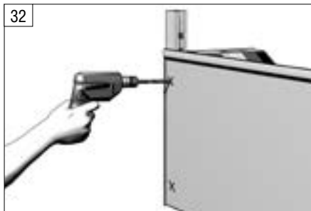
32 Просверлите отверстия в задней части короба под заклепки Ø4 мм.
