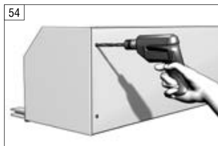
54 Просверлите отверстия в верхней части короба под заклепки Ø4 мм.
