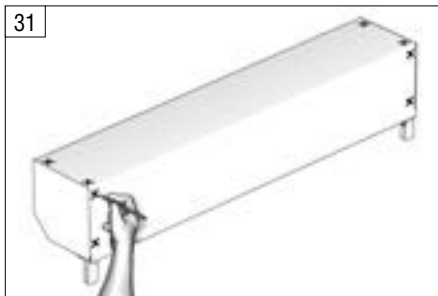
31 Отметьте места для сверления отверстий под заклепки.
