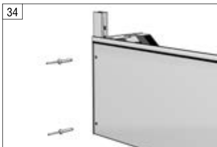
34 Закрепите заклепки в задней части короба.
