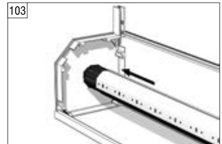
103 Выдвиньте универсальную капсулу из вала, до упора в крышку.
