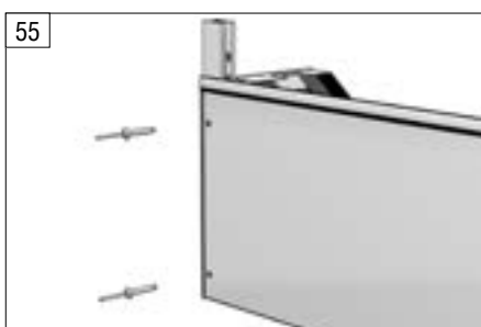
55 Прикрепите боковую крышку к коробу со стороны привода при помощи заклепок.
