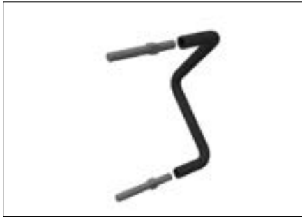
Вкрутите винты короткой частью в резьбовые отверстия ручки на глубину 2-3 мм.
