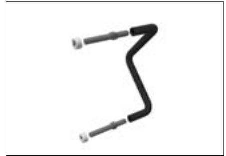
На квадратную часть винта наденьте гайку.
