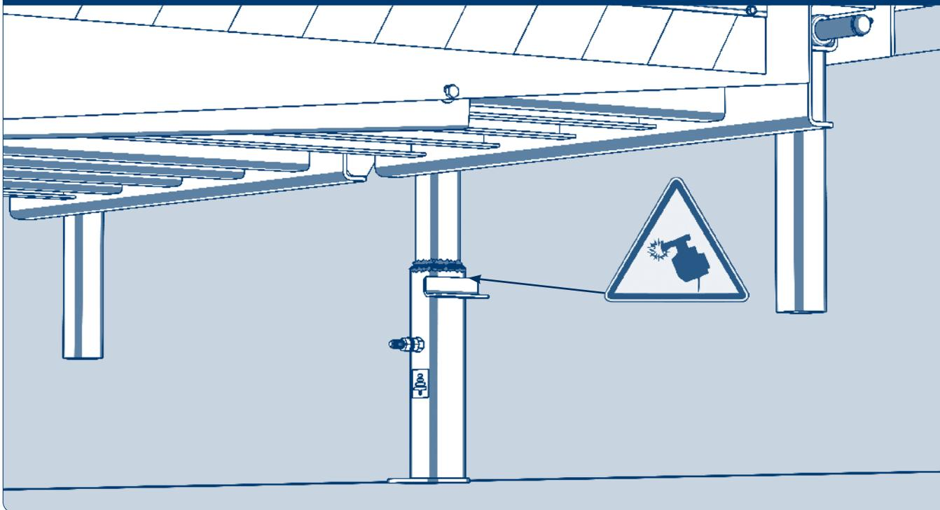
Подключите блок управления к уравнильной платформе в соответствии с инструкцией на данный блок. Сделайте 4–5 полных цикла открытия-закрытия, убедитесь что платформа работает в штатном режиме.
