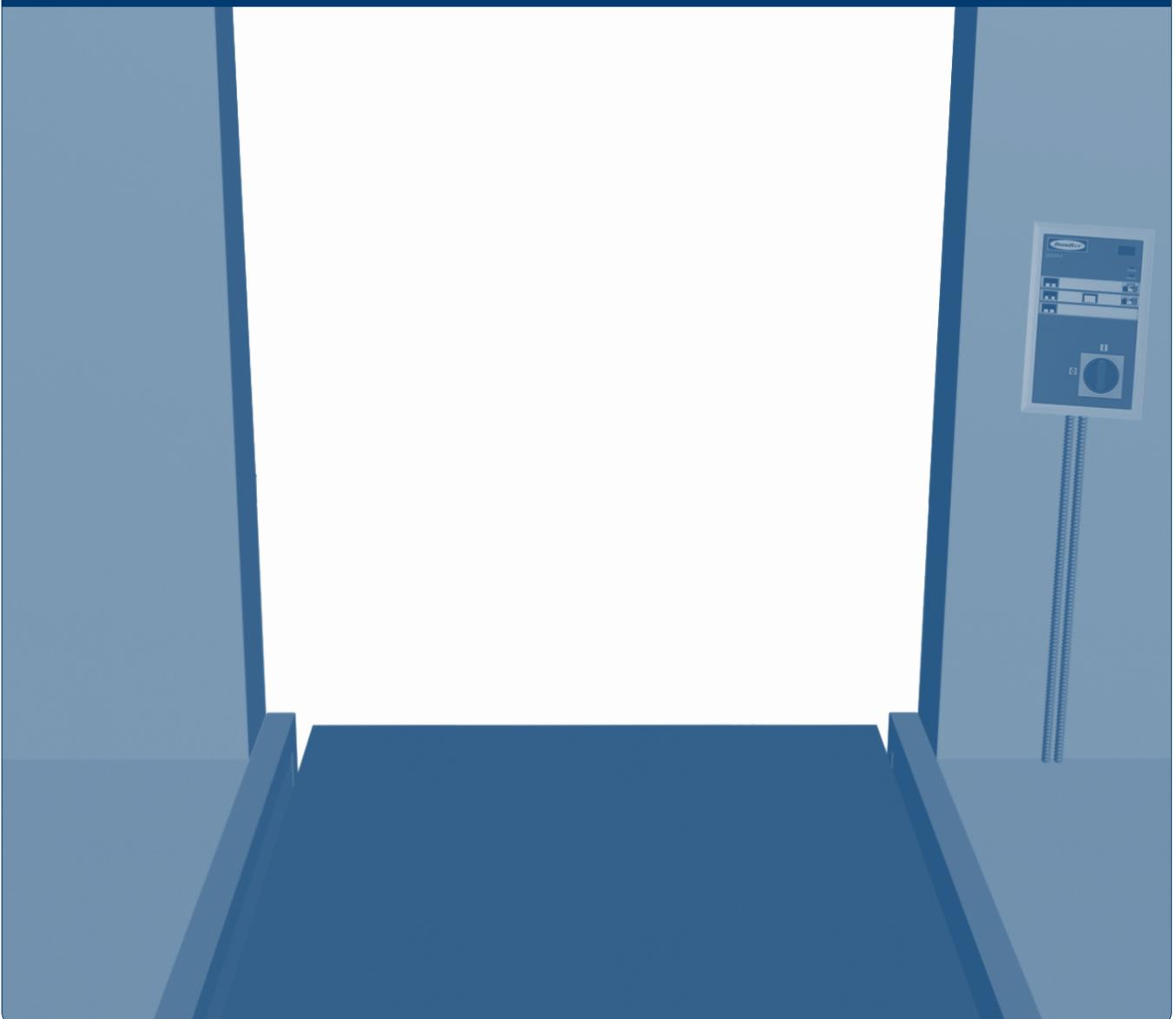
Блок управления необходимо монтировать так, чтобы оператор всегда мог контролировать процесс управления уравнительной платформой.
