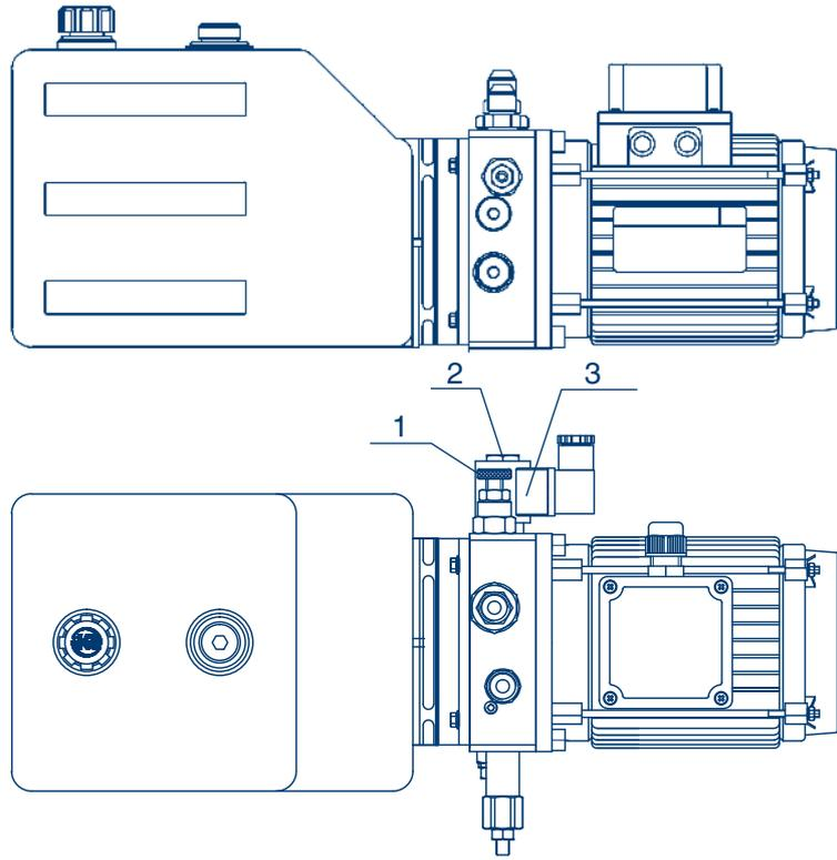
Рис. 4. Насос гидравлический SKS с двумя подъемными цилиндрами
